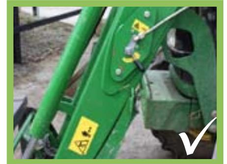
Les appareils de levage doivent aussi porter une étiquette mentionnant la capacité maximale de levage.
